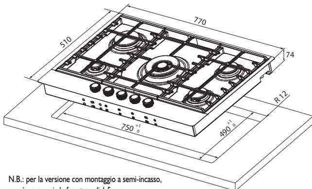
N.B.: per la versione con montaggio a semi-incasso, non è necessaria la fresatura di 1,5 mm.
