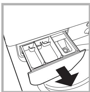
Izvucite pretinac podižući ga i povlačeći prema vani (*vidi sliku*). Operite ga u tekućoj vodi; ovo čišćenje treba često vršiti.
