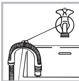
Druga mogućnost je da crijevo za odvod prebacite preko ruba umivaonika ili kade tako da vodilicu (koja se može kupiti u centru za tehničku pomoć) pričvrstite na slavinu (vidi sliku). Slobodni završetak odvodne cijevi ne
