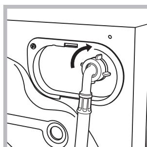
2. Spojite dovodnu cijev na perilici navijanjem na odgovarajući otvor za uzimanje vode na stražnjoj strani gore desno (*vidi sliku*).
