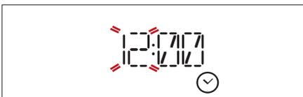
Den *Einstellknopf* drücken, um die korrekte Uhrzeit einzustellen und
