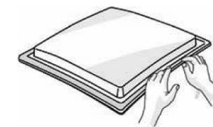
Coloque a placa na abertura da bancada feita respeitando as dimensões indicadas no manual de instruções.
