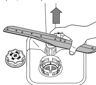
Нижнюю лопасть можно снять, потянув ее вверх.
