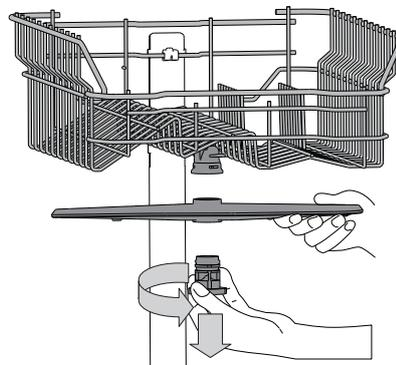
Для снятия верхней лопасти поверните пластмассовое удерживающее кольцо против часовой стрелки. Устанавливайте верхнюю лопасть так, чтобы сторона с большим количеством отверстий была обращена вверх.
