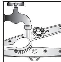
Limpie las boquillas de los aspersores con agua corriente (utilice palillos, si fuera necesario)...
