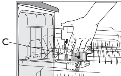
**Cómo desmontar el cesto superior** (si es posible): puede ser útil desmontar el cesto superior para colocar cosas que abultan en el cesto inferior.
