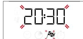
Za nastavitev časa konca priprave pritisnite + ali - in za potrditev . Funkcijo vklopite tako, da gumb za nastavitev temperature zavrtite v položaj želene temperature: funkcija ostane prekinjena, dokler se ne zažene samodejno v času, izračunanem glede na izbrani čas konca kuhanja.
