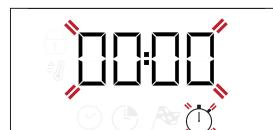
Upotrijebite + ili - za postavljanje vremena i pritisnite za potvrdu. Kada mjerac vremena završi s odbrojavanjem odabranog trajanja oglasit će se zvučni signal.
