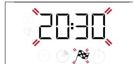
Χρησιμοποιήστε το + ή το - για να ρυθμίσετε την ώρα που θέλετε να τελειώσει το μαγείρεμα και πιέστε το για επιβεβαίωση. Ενεργοποιήστε τη λειτουργία στρέφοντας τον επιλογέα θερμοστάτη στην επιθυμητή θερμοκρασία: η λειτουργία θα παραμείνει σε παύση μέχρι να ξεκινήσει αυτόματα στον χρόνο που υπολογίζεται με βάση την επιλεγμένη ώρα λήξης μαγειρέματος.
