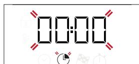
Χρησιμοποιήστε το + ή το - για να ρυθμίσετε το χρόνο ψησίματος και πατήστε το για επιβεβαίωση. Ενεργοποιήστε τη λειτουργία στρέφοντας τον επιλογέα θερμοστάτη στην επιθυμητή θερμοκρασία. Εκπέμπεται ένα ηχητικό σήμα και στην οθόνη εμφανίζεται η ένδειξη ότι το μαγείρεμα ολοκληρώθηκε.
