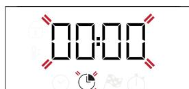
Upotrijebite + ili - za postavljanje potrebnog vremena pečenja i pritisnite za potvrdu. Funkciju uključite okretanjem gumba termostata na potrebnu vrijednost temperature. Oglasit će se zvučni signal i na zaslonu će se označiti da je pečenje završeno.
