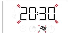
Upotrijebite + ili - za postavljanje željenog vremena završetka i pritisnite za potvrdu. Funkciju uključite okretanjem gumba termostata na potrebnu temperaturu: funkcija ostaje pauzirana sve dok se ne pokrene automatski u vrijeme izračunato na temelju vremena završetka pripreme hrane.
