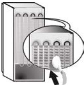
Para garantizar un flujo continuo y correcto del agua de descongelación, limpie regularmente el interior del orificio de drenaje en la parte trasera del refrigerador cerca del cajón para frutas y verduras, con la herramienta incluida a estos efectos.
