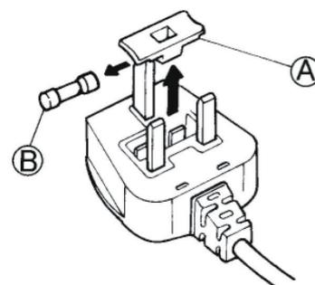
1. Desmonte la tapa del fusible (A) y el fusible (B).
