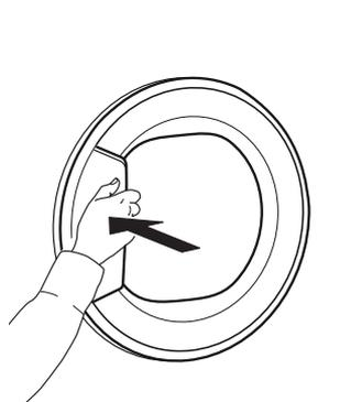
Si interrumpe un programa en funcionamiento abriendo la puerta, el programa se reiniciará si no se vuelve a cerrar la puerta de la secadora en el plazo de un minuto.
