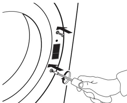
**8.** Introduzca la clavija de contacto en la parte superior del interior de la puerta. Gire la clavija de contacto con alicates 90 °C hacia la derecha, para fijarla.
