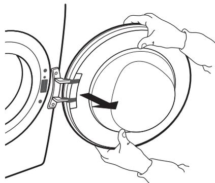
**5.** Fije la puerta a la izquierda enroscando los dos tornillos. Procure enroscarlos en vertical, para no pellizcar la junta de la puerta.
