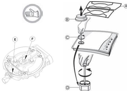
Antes de instalar a placa, não se esqueça de afixar a placa de calibração do gás fornecida com os injetores, de forma que esta cubra a informação anterior relativa à calibração de gás.
