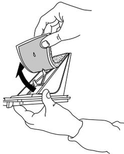
Fije la espuma del filtro en el filtro inferior. Limpie la cámara del filtro de la secadora con un paño o cuidadosamente con una aspiradora. Vuelva a introducir el filtro inferior. Encaje el asa del filtro hacia abajo y cierre la tapa inferior.
