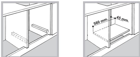
Nel caso di installazione sopra un forno da incasso senza ventilazione forzata di raffreddamento, per consentire un'adeguata aerazione all'interno del mobile vanno garantite delle prese d'aria di ingresso e di uscita (vedi figure).
