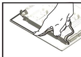
Applicare le guarnizioni in dotazione con l'apparecchio sui bordi esterni del piano cottura, per impedire il passaggio d'aria, umidità ed acqua (vedi figura). Per una corretta applicazione assicurarsi che le superfici da sigillare siano pulite, asciutte ed esenti da grassi/oli.
