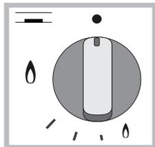
Per passare da un livello all'altro è sufficiente ruotare la manopola verso il livello prescelto.
