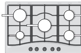
L'aspetto più variabile in termini di stabilità delle pentole può essere spesso la pentola stessa (o il suo posizionamento durante l'uso). Pentole ben bilanciate, con fondi piatti, centrate sul bruciatore, con le maniglie posizionate in linea con una delle
