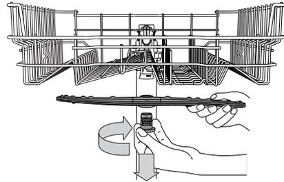
Para extraer el brazo aspersor superior, gire el anillo de cierre de plástico hacia la derecha. El brazo rociador superior se tiene que recolocar de tal modo que el lado con más agujeros mire hacia arriba.
