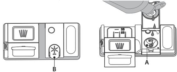
1. Abra el dispensador **B** pulsando y subiendo la lengüeta de la cubierta.
