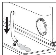
3. Περιστρέψτε τη λαβή του φίλτρου εξαγωγής και τραβήξτε το από το περιβλήμα.
