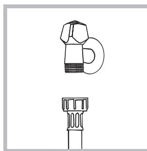
1. Συνδέστε το σωλήνα τροφοδοσίας βιδώνοντάς τον σε ένα κρουνό κρύου νερού με στόμιο σπειρώματος 3/4 (βλέπε εικόνα). Πριν τη σύνδεση, αφήστε να τρέξει το νερό μέχρι να γίνει διαυγές.
