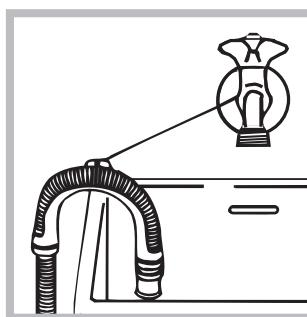
In alternativa, appoggiare il tubo di scarico al bordo di un lavandino o di una vasca, legando la guida (acquistabile presso il servizio assistenza) al rubinetto (vedi figura). L'estremità libera del tubo di
