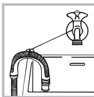
Autrement, accrocher le tuyau de vidange à un évier ou à une baignoire, dans ce cas, attacher la crosse (à acheter au service d'assistance) au robinet (voir figure). L'extrémité libre du tuyau d'évacuation ne doit pas être plongée dans l'eau.
