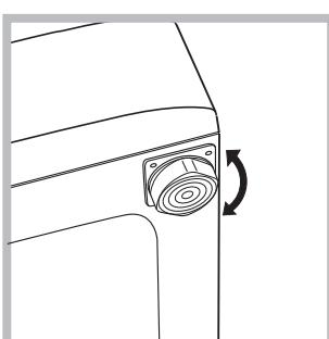
2. Se o pavimento não for perfeitamente horizontal, para compensar qualquer irregularidade, desatarraxe ou atarraxe os pés dianteiros (veja a figura); o ângulo de inclinação, medido no plano de trabalho, não deve ultrapassar 2°.
