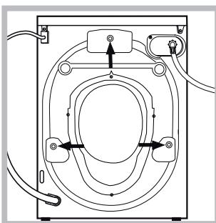
3. Tire os **3** parafusos de protecção para o transporte e a borra-chinha com o respectivo calço, situados na parte traseira (veja a figura).
