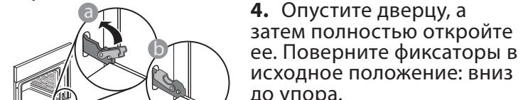
**4. Опустите дверцу,** а затем полностью откройте ее. Поверните фиксаторы в исходное положение: вниз до упора.
