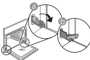
**1. Для снятия дверцы** полностью откройте ее и откиньте фиксаторы в положение разблокировки.
