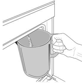
Uma vez selecionada a função "Drain" (Drenagem), siga as ações indicadas: Abra a porta e coloque um recipiente grande por baixo do bico de drenagem localizado na parte inferior direita do painel. Uma vez iniciada a drenagem, mantenha o recipiente em posição até que a drenagem esteja concluída. A duração
