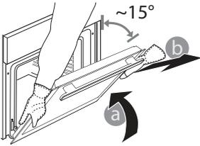
**Reponha a porta**, deslocando-a na direção do forno e alinhando os ganchos das dobradiças com os respetivos suportes, fixando a parte superior aos suportes.
