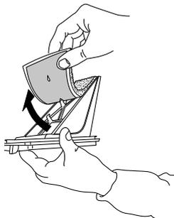
Fije la espuma del filtro en el filtro inferior. Limpie la cámara del filtro de la secadora con un paño o cuidadosamente con una aspiradora. Vuelva a introducir el filtro inferior. Encaje el asa del filtro hacia abajo y cierre la tapa inferior.
