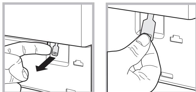
4. utilizando la lengüeta indicada en la figura, tire hacia fuera hasta liberar la varilla de plástico del retén; tire posteriormente hacia abajo hasta sentir un breve sonido que indica que la puerta está desbloqueada.
