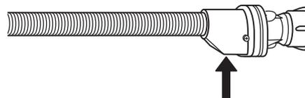
Per i tubi anti-allagamento: controllare la finestrella di ispezione della valvola di sicurezza (vedere la freccia). Se è rossa, significa che la funzione anti-allagamento si è attivata; in questo caso il tubo deve essere sostituito con uno nuovo.
