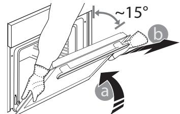
3. Ukse tagasipaigaldamiseks asetage see vastu ahju, joondage hingedede haagid pesadega ja kinnitage ülemine osa oma pessa.
