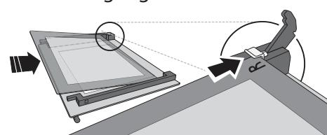
**4. Die obere Ecke wieder anbringen:** ein Klick bestätigt die richtige Positionierung. Sicherstellen, dass die Dichtung vor Wiedereinbau der Tür befestigt wird.
