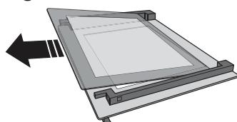
**3. Bringen Sie die Zwischenscheibe wieder an** (gekennzeichnet mit "R") bevor Sie die Innenscheibe wieder einbauen: Um das Glasscheiben richtig einzusetzen, sicherstellen, dass das Zeichen „R“ in der linken Ecke sichtbar ist. Zuerst die lange Seite des Glas, die mit einem „R“ gekennzeichnet ist in die Halterungen einsetzen, dann in die Position absenken. Wiederholen Sie diesen Vorgang bei beiden Glasscheiben.
