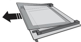
3. Vuelva a colocar la hoja intermedia (marcada con "R") antes de volver a colocar la hoja interna: Para colocar las hojas de cristal correctamente, asegúrese de que la marca «R» se vea en la esquina de la izquierda. Primero introduzca el lado largo del cristal marcado con una "R" en los soportes y después bájelo hasta su posición. Repita este procedimiento en ambas hojas de cristal.
