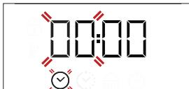
Gebruik + of - om de uren in te stellen en druk op ☰ om te bevestigen. Op het display gaan de twee cijfers die de minuten aangeven knipperen.
