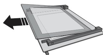
**3. Pirms iekšējās rūts ievietošanas ievietojiet atpakaļ vidējo rūti (markēta ar zīmi "R"): Lai pareizi ievietotu stikla rūtis, pārbaudiet, vai "R" zīme atrodas kreisajā stūrī. Vispirms ievietojiet balstos stikla garāko pusī, kas ir markēta ar "R" zīmi, un nolaidiet to. Atkārtojiet ar abām stikla rūtīm.**
