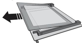
3. Ponovo postavite srednje okno (obeleženo slovom „R“) pre postavljanja unutrašnjeg okna: Da biste pravilno postavili staklena okna, vodite računa da oznaka „R“ može da se vidi u levom uglu. Prvo ubacite dužu stranu stakla obeleženu slovom „R“ u ležišta, a potom ga spustite na položaj. Ovu proceduru ponovite za oba staklena okna.
