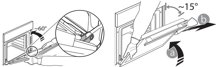
**3. Remontați ușa** deplasând-o spre cupitor, aliniind cuplajele balamalelor cu locașurile și fixând partea superioară în locaș.
