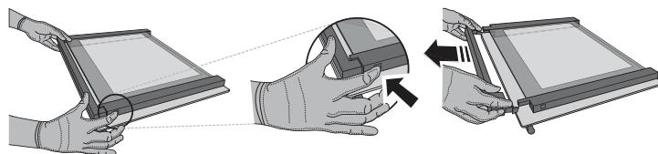
2. Podignite i čvrsto držite unutrašnje staklo sa obe ruke, skinite ga i postavite na mekanu površinu pre nego što počnete sa čišćenjem.
