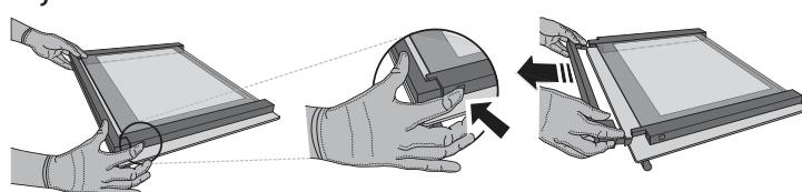
**2.** Zvedněte a pevně držte vnitřní sklo oběma rukama, přeneste sklo na měkký povrch. Poté začněte s čištěním.
