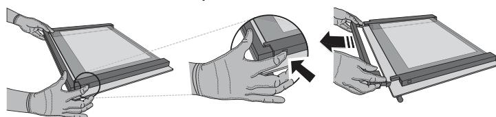
2. Hoidke sisemist klaasi kindlalt mõlema käega ja töstke see üles, eemaldage ukse küljest ja pange puhastamiseks pehmele pinnale.
