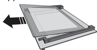
**3. Herplaats het middenpaneel** (gemarkeerd met "R") voordat u het binnenvuurpaneel terugplaats: Om de ruiten correct terug te plaatsen, zorg ervoor dat het merk "R" zichtbaar is in de linkerhoek. Breng eerst de lange zijde van de ruit met het merk "R" in de zittingen, en breng de ruit omlaag tot die op zijn plek komt. Herhaal deze procedure voor beide glasruit.
