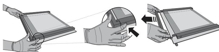
**2. Hef en hou de binnenruit stevig vast met beide handen, verwijder het en leg het op een zacht oppervlak vooraleer het te reinigen.**
