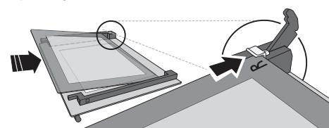
**4.** Namontujte horní lištu: Zavaknutí indikuje správnou montáž. Před nasazením dvířek zkonzolujte těsnění.
