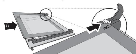
**4. Montați la loc marginea superioară:** Poziționarea corectă se realizează după ce se aude un clic. Asigurați-vă că garnitura este fixată sigur înainte de a remonta ușa.
