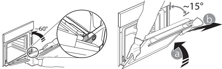
3. Réinstallez la porte en la plaçant devant le four pour aligner les crochets des charnières avec leurs appuis et attacher la partie supérieure sur son appui.
