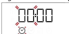
Utilice + o - para ajustar la hora y pulse para confirmar. Los dos dígitos de los minutos empezarán a parpadear.
