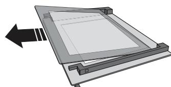
**3. Montați la loc panoul intermediar (marcat cu „R”)** înainte de a remonta panoul interior: Pentru a poziționa corect panourile de sticlă, asigurați-vă că marcajul „R” poate fi observat în colțul din partea stângă. Mai întâi, introduceți latura lungă a geamului marcată cu litera „R” în locașurile de susținere, apoi coborâți-o în poziție. Repetați această procedură pentru ambele panouri de sticlă.
