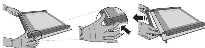
**2. Ridicați și țineți ferm cu ambele mâini geamul interior, demontați-l și amplasați-l pe o suprafață moale înainte de a-l curăța.**
