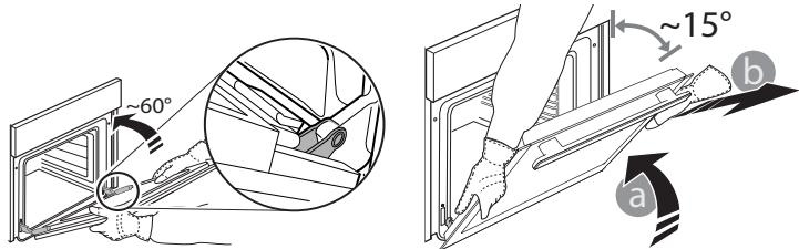
3. Vuelva a instalar la puerta llevándola hacia el horno, alineando los ganchos de las bisagras con sus alojamientos y fijando la parte superior en su alojamiento.
