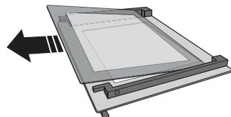
**3. Встановіть проміжну панель (позначена літерою R) перед встановленням внутрішньої панелі: Щоб правильно встановити скляні панелі, переконайтесь, що в лівому кутку видно позначку R. Спочатку вставте довгу сторону скла, позначену літерою R, в опорні гнізда, а потім опустіть його на місце. Повторіть цю процедуру для обох скляних панелей.**
