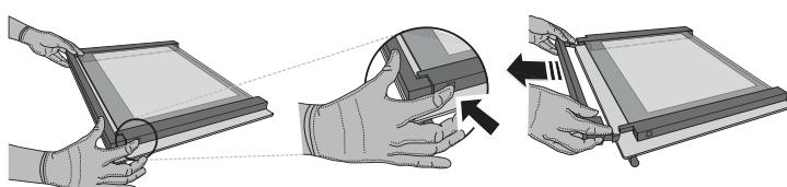
**2. Das Innenglas mit beiden Händen anheben und fest halten**, es entfernen und auf eine weiche Fläche legen, um es daraufhin zu reinigen.
