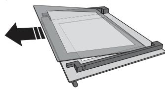
3. Paigaldage uuesti vaheplaat (tähisstatud R-tähega) enne siseplaadi paigaldamist: Klaastahvlite õige asetuse jaoks veenduge, et tähis "R" jäääb vasakusse nurka. Kõigepealt pange klaasi pikk külg (märgitud R-tähega) tugevale, seejärel langetage see paika. Korraage sama mõlema klaastahvliga.
