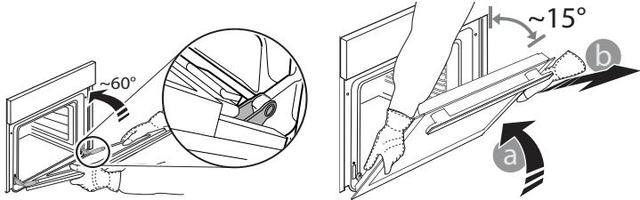
**3.** Dvírka opět nasadíte tak, že je přiložíte k troubě, nasmerujete háčky pantů oproti jejich usazení a do příslušného usazení zajistíte i horní část.
