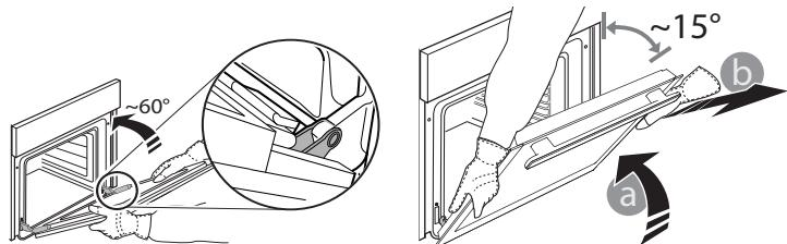
**3. Įstatydami dureles pastumkite jas link orkaitės, sulygiuokite vyrių kabliukus tvirtinimo vietose ir užfiksuodami viršutinę dalį.**
