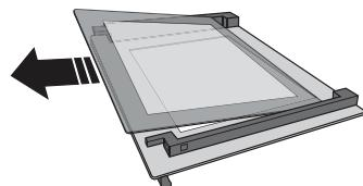
**3. Ponownie zamontować środkowy panel (oznaczony literą "R") przed przystąpieniem do montażu panelu wewnętrznego:** Aby właściwie umieścić szyby, należy upewnić się, że znak „R” jest widoczny w lewym rogu. W pierwszej kolejności należy umieścić dłuższą część szyby oznaczoną literą „R” w odpowiednich uchwytnach, a następnie obniżyć ją do właściwej pozycji. Powtórzyć tę procedurę dla obu szyb.
