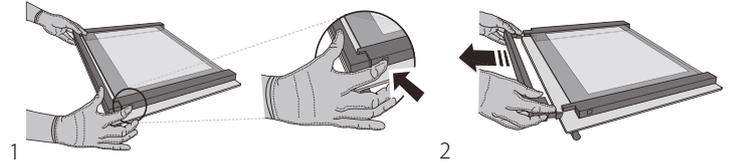
Levante e segure firmemente o vidro interior com ambas as mãos, removendo-o e colocando-o sobre uma superfície suave antes de proceder à sua limpeza (3).
