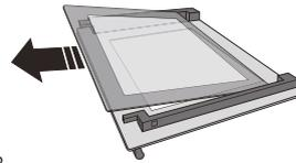
Para voltar a instalar o vidro interior, certifique-se de que a letra "R" está visível no canto esquerdo e que a superfície límpida (não impressa) está voltada para cima. Insira primeiro a parte mais longa do vidro com a indicação "R" nos alojamentos dos suportes e, em seguida, baixe-a até à posição correta (4). Instale novamente a extremidade superior (5): irá ouvir um clique, indicando que está bem posicionado. Certifique-se de que a vedação está segura antes de montar novamente a porta.
