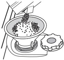
1. Togliere il cestello inferiore e svitare il tappo del serbatoio (ruotare in senso antiorario).
