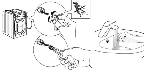
4. Introduza novamente o filtro. Ligue novamente a mangueira de entrada à torneira da água e à máquina de lavar. Não utilize uma ferramenta para ligar a mangueira de entrada. Abra a torneira e assegure-se de que todas as ligações estão bem apertadas.
