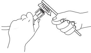
3. De seguida, desaperte manualmente a mangueira de entrada na parte de trás da máquina de lavar. Com alicates, extraia o filtro da válvula na parte de trás da máquina de lavar e limpe-o cuidadosamente.
