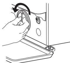
9. Remova o filtro: Estenda um pano de algodão por baixo do filtro de água, que possa absorver uma pequena quantidade de água residual. Em seguida, remova o filtro de água rodando-o no sentido contrário dos ponteiros do relógio.
