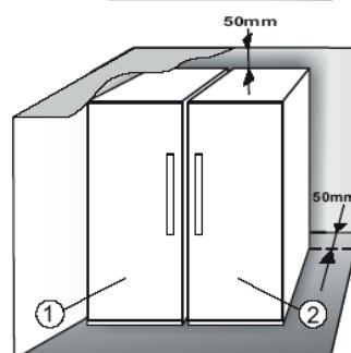
Si consiglia di installare insieme i due apparecchi utilizzando il kit di collegamento ③ (come mostrato in figura).
