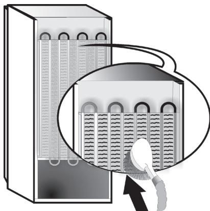
قبل القيام بأي عملية تنظيف أو صيانة، افصل الجهاز عن الشبكة الكهربائية أو افصل مصدر الإمداد بالتيار الكهربائي.
