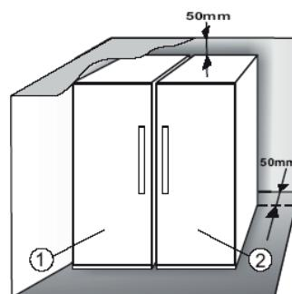
Nous vous recommandons d'installer les deux appareils ensemble à l'aide de la trousse d'attaches ③ (comme illustré sur l'image).
