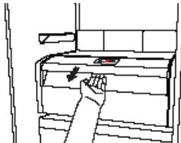
Para optimizar el consumo de energía, se recomienda desactivar el «Cajón cero grados» y retirarlo.
