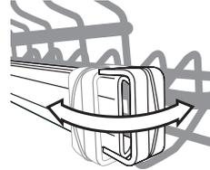
Ouvrir les butées installées à droite et à gauche et sortir le panier.
