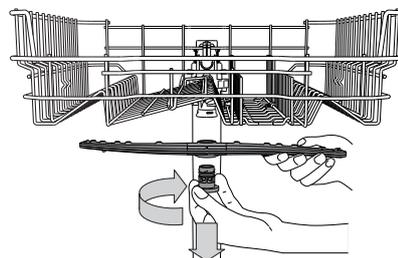
Para retirar o braço aspersor superior, rode o anel de bloqueio de plástico no sentido dos ponteiros do relógio. O braço aspersor superior deve ser recolocado de modo a que o lado com mais orifícios fique voltado para cima.
