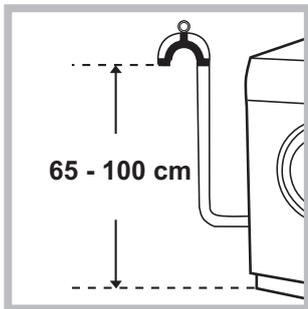
Schließen Sie den Ablaufschlauch ohne ihn dabei abzuknicken an einen geeigneten Abfluss an. Die Mindestablaufhöhe beträgt 65 - 100 cm (gemessen vom Boden), oder hängen Sie diesen mittels des Schlauchhalters gesichert in
