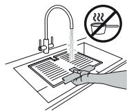
5. Ostavite element da se osuši, a plastične dijelove obrišite mekanom krpicom.
