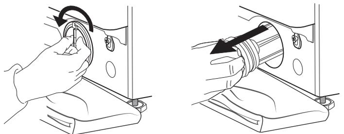
**5.** Limpiar el filtro de agua: retire los residuos del filtro y lávelo con agua corriente.
