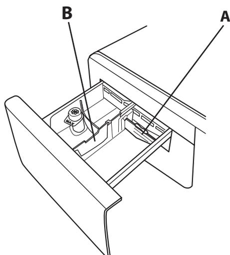
Use preferentemente la partición **A** si utiliza detergente líquido para lavar; así se asegura el uso de la cantidad correcta de detergente (la partición se incluye en la bolsa con las instrucciones). Si usa detergente en polvo, coloque la partición en la ranura **B**.
