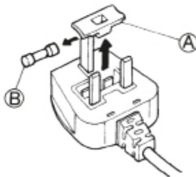
1. Retire la tapa del fusible (A) y el fusible (B).
