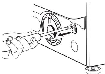
**4.** Después, vuelva a conectar el cable introduciendo el tornillo con un destornillador.
