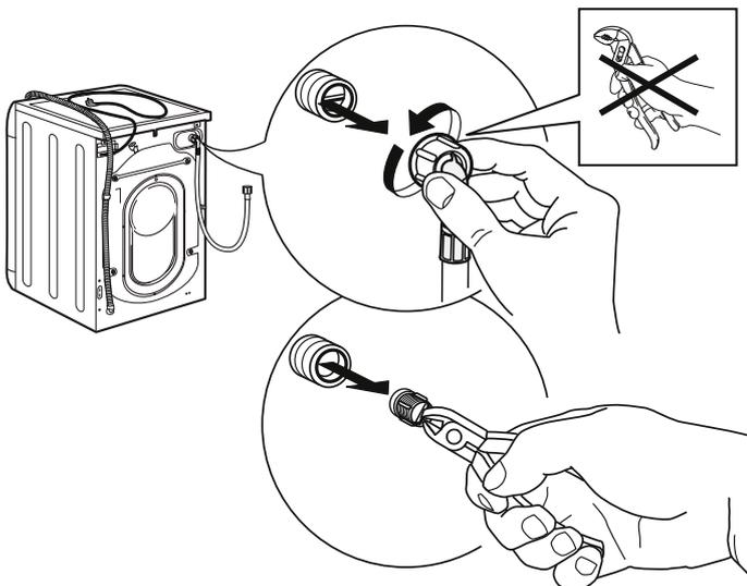
**4.** Vuelva a introducir el filtro de malla. Vuelva a conectar la manguera al grifo y a la lavadora secadora. No utilice herramientas para conectar la manguera. Abra el grifo y compruebe que todas las conexiones estén bien ajustadas.
