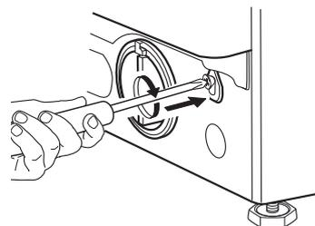
**3.** Tire del cable hacia abajo tal como se indica en la figura siguiente. Entonces la puerta se desbloquea y se puede sacar la ropa.
