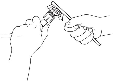
**3.** Después, desenrosque manualmente la manguera de entrada de agua de la parte trasera de la lavadora secadora. Extraiga el filtro de malla de la válvula de la parte trasera de la lavadora secadora con unas pinzas y límpielo.
