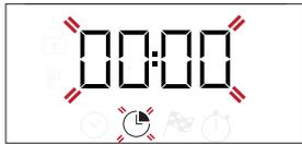
Aseta haluamasi kypsennysaika käyttämällä **+** tai **-** ja vahvista sitten painamalla . Aktivoi toiminto kääntämällä lämpötilan valitsin haluamasi lämpötilan kohdalle. Laite toistaa äänimerkin ja näytöllä näkyy, että kypsennys on suoritettu.
