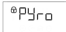
När programmet är klart förblir luckan låst tills temperaturen i ugnen har sjunkit till en säker nivå. Vädra rummet under och efter pyrolysurengöringsprogrammet.
