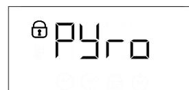
Når cyklussen er fuldført, forbliver lågen blokeret indtil temperaturen inde i ovnen er faldet til et sikkert niveau. Udluft rummet under og efter en Pyro-cyklus.
