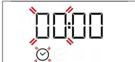
Använd **+** eller **-** för att ställa in timmen och tryck på för att bekräfta. De två siffrorna för minuterna börjar blinka. Använd **+** eller **-** för att ställa in minuterna och tryck på för att
