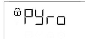
Kun jakso on päättynyt, luukku pysyy lukittuna kunnes uunin sisälämpötila on palannut turvalliselle tasolle. Tuuleta huonetta Pyro-jakson aikana sekä sen jälkeen.
