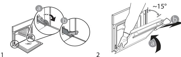
Ponovno postavite vrata pomičući ih prema pećnici, poravnavajući kuke šarki s ležištima i učvršćujući gornji dio na njegovo ležište. Spustite vrata pa ih otvorite do kraja. Šarke spustite u njihov početni položaj (3): Provjerite jeste li ih spustili do kraja. Lagano pritisnite kako biste provjerili jesu li šarke u ispravnom položaju.
