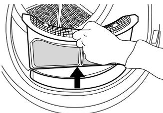
Pulse el botón para abrir el filtro de la puerta. Elimine la pelusa que contenga. Cierre el filtro y reintrodúzcalo en la dirección correcta, de manera que se integre por completo en la cámara del filtro.
