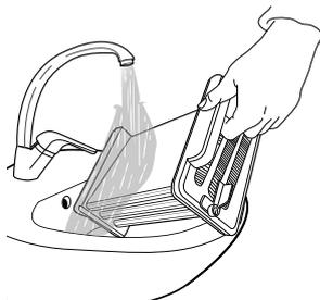
Limpié la cámara del filtro de la secadora con un paño o con una aspiradora. Vuelva a introducir el filtro inferior. Gire las barras de cierre hacia arriba en posición vertical. Cierre la tapa inferior.
