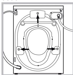
3. Tire os **3** parafusos de protecção para o transporte e a borra-chinha com o respectivo calço, situados na parte traseira (veja a figura).
