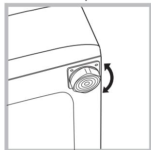
2. Ако подът не е идеално хоризонтален, компенсирайте неравностите, като отвиете или завиете предните крачета (виж фигураната); ъгълът на наклона, измерен върху работната повърхност, не трябва да надвишава 2°.
