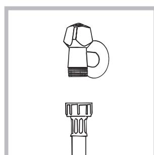
1. Conectar el tubo de tubo enroscándolo a un grifo de agua fría con la boca roscada de 3/4 (*ver la figura*). Antes de conectarlo, haga correr el agua hasta que esté limpia.
