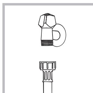
1. Realize a ligação do tubo de alimentação parafusando-o a uma torneira de água fria com bocal de rosca de 3/4 (veja a figura).
