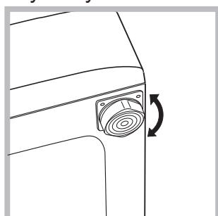
2. Yerleştirilecek zemin tam düz değilse çamaşır makinesinin vidalı ön ayaklarını sıkarak ve ya gevşeterek dengeyi sağlayınız (bkz. şekil); eğim açısı, makinanın üst tezgahına göre 2° den fazla olmamalıdır.
