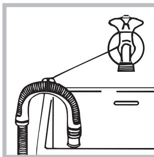
Otra alternativa es apoyar el tubo de desagüe en el borde de un lavamanos o de una bañera, uniendo la guía (puesta a disposición para la venta por el servicio de asistencia) al grifo (ver figura). El extremo libre del tubo de descarga
