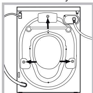
3. Koruyucu 3 vidayı (nakliye sırasında kullanılır) ve cihazın arkası kısımı yerleştirilen ilgili parça ile birlikte lastik contayı çıkarın (şekle bakınız).
