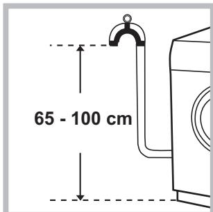
Ligue o tubo de descarga, sem dobrá-lo, a um conduto de descarga ou a uma descarga de parede colocados entre 65 e 100 cm do chão;
