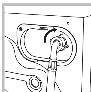
2. Besleme hortumunu arka kısmda üst sağ köşedeki su girişine vidalayarak çamaşır makinesine takınız (bkz. şekil).
