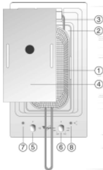
1. Panier avec crochet d'égouttage et poignée repliable
