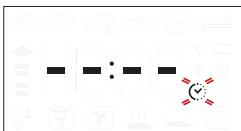
Cuando parpadee el icono en la pantalla, utilice el selector de ajuste para ajustar el tiempo de cocción necesario y luego pulse para confirmar.
