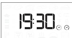
Veuillez noter : La programmation d'un délai pour le début de la cuisson désactive la phase de préchauffage. Le four va atteindre la température désirée graduellement, ce qui signifie que les temps de cuisson vont être légèrement plus longs que ceux indiqués sur le tableau de cuisson.
