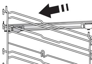
Fixe o encaixe superior da corrediça à guia de nível e faça-a deslizar até parar. Baixe o outro encaixe para o posicionar.
