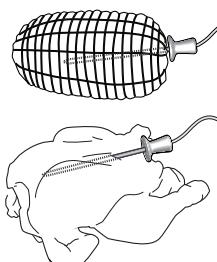
avant de la retirer du four. Brancher l'extrémité de la sonde dans le trou situé sur la paroi droite de la cavité du four. Quand la sonde à viande est insérée dans la cavité du four, un signal sonore est activé et l'écran présente l'icône et la température à atteindre.
