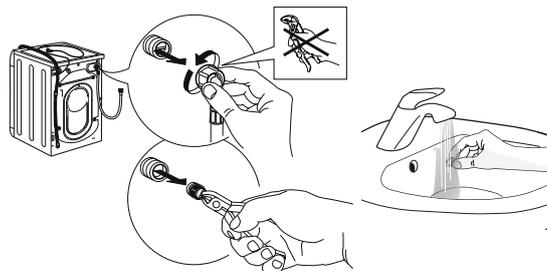
4. Вставте сітчастий фільтр на місце. Знову приєднайте шланг до крана подачі води й пральної машини. Не користуйтеся інструментами для приєднання шланга. Відкрийте кран подачі води й перевірте, чи щільні всі з'єднання.
