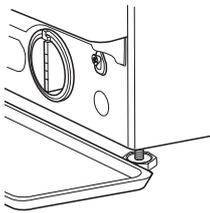
3. Злийте воду: повільно поверніть фільтр проти годинникової стрілки, поки не витече вся вода. Дайте воді стекти, не виймаючи фільтра. Коли контейнер наповниться, закрийте фільтр, повернувши його за годинниковою стрілкою. Злийте воду з контейнера. Повторіть процедуру, поки не буде злита вся вода.
