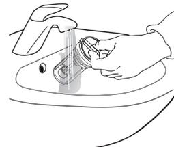
6. Вставте водяний фільтр і поверніть на місце плінтус: вставте фільтр на місце, повернувши його за годинниковою стрілкою. Обов'язково поверніть фільтр до упору, при цьому ручка фільтра має бути у вертикальному положенні. Для перевірки пропускної спроможності фільтра залийте близько 1 літра в дозатор засобу для прання. Потім установіть плінтус на місце.
