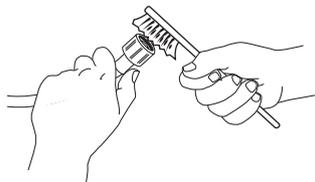
3. Потім вручну викрутіть шланг подачі ззаду пральної машини. Витягніть сітчастий фільтр з клапану в задній частині машини плоскогубцями й обережно очистьте його.
