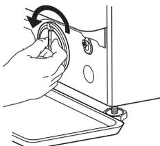
4. Зніміть фільтр: покладіть під водяний фільтр бавовняний рушник, який може ввібрати невелику кількість води. Потім зніміть водяний фільтр, повернувши його проти годинникової стрілки.
