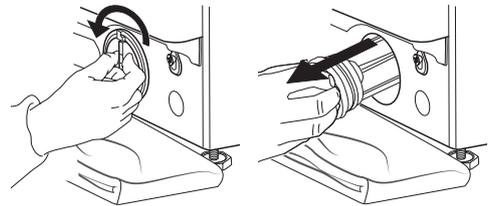
5. Очистьте водяний фільтр. Видаліть залишки у фільтрі і промийте його під проточною водою.
