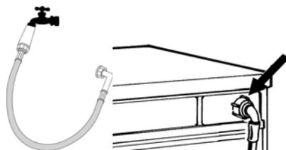
8. - Si votre lave-linge compte deux vannes d'arrivée d'eau sur sa partie arrière, **vous devez raccorder les deux vannes à l'arrivée d'eau :**
