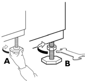
5. - Réglez la hauteur de chaque pied en les tournant. Notez que la distance entre le bas de la carrosserie du lave-linge et le sol ne doit pas être supérieure à 20 mm.
