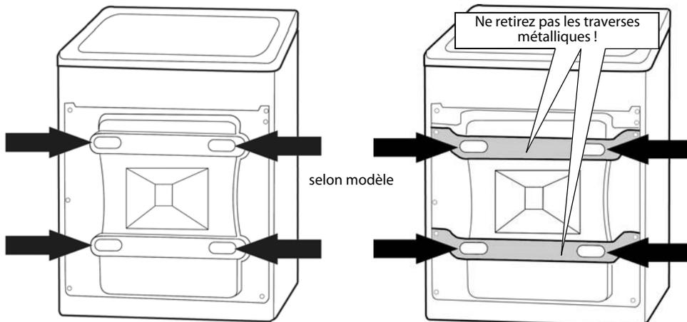
1. - Dévissez les 4 vis du bridage de transport à l'aide d'une clé de 12 mm ; les vis sont longues et doivent être dévissées pendant un certain temps avant de pouvoir être retirées.
