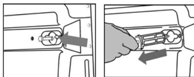
3. - Pour obturer les orifices, insérez les bouchons en plastique fournis dans la section large, puis faites-les glisser vers l'extérieur du lave-linge jusqu'à ce qu'ils s'encastrerent dans leur logement.
