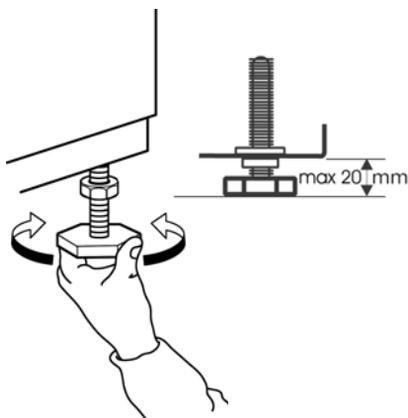
6. - Remarque importante : serrez le contre-écrou en le tournant dans le sens inverse des aiguilles d'une montre, vers le lave-linge.
