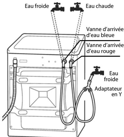
Vissez à la main le tuyau d'arrivée d'eau sur le robinet et sur la vanne d'arrivée d'eau, puis serrez l'écrou. **N'utilisez aucun outil pour serrer le tuyau d'arrivée d'eau.**
