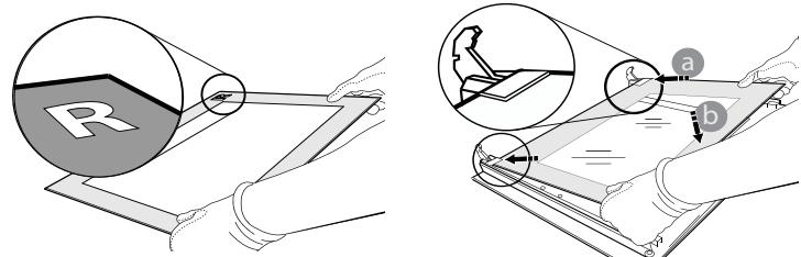
**4.** Зафиксируйте верхний край: Щелчок означает правильную установку. Перед установкой дверцы проверьте целостность уплотнения.
