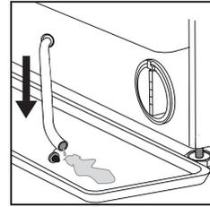
3. Rode a pega do filtro de saída e retire-o para fora do alojamento. Quando o recipiente do rodapé estiver cheio de água, coloque a tampa na extremidade da mangueira e reintroduza a pequena mangueira na base da máquina de lavar. De seguida, esvazie o recipiente. E depois tape com firmeza a mangueira de drenagem de emergência com a tampa.
