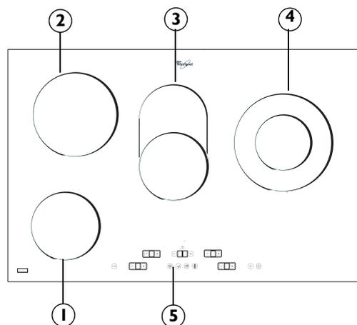
1. Zona de cocción radiante Ø 145 mm
