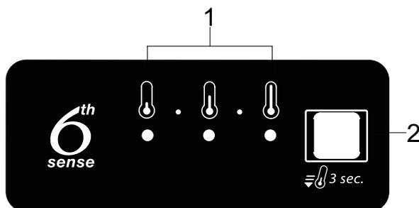
1. LEDs indicadores (apresentam a atual temperatura programada ou a função de Arrefecimento Rápido)
