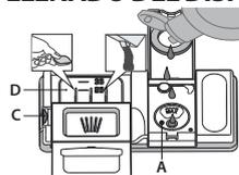
El abrillantador facilita el SECADO de la vajilla. El dispensador de abrillantador **A** se debe rellenar cuando el **indicador luminoso ABRILLANTADOR** del panel de control se encienda.
