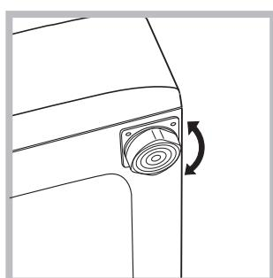
2. Si le sol n'est pas parfaitement horizontal, visser ou dévisser les pieds de réglage avant (*voir figure*) pour niveler l'appareil; son angle d'inclinaison, mesuré sur le plan de travail, ne doit pas dépasser 2°.
