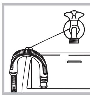
ou bien l'accrocher à un évier ou à une baignoire, dans ce cas, fixer le support en plastique fourni avec l'appareil au robinet (*voir figure*). L'extrémité libre du tuyau d'évacuation ne doit pas être plongée dans l'eau.
