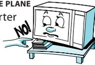
**PLACEZ LE FOUR À DISTANCE** d'autres sources de chaleur. Laissez un espace de 30 cm minimum au-dessus du four afin de garantir une ventilation suffisante. L'appareil doit être placé contre un mur. Assurez-vous que l'espace en-dessous, au-dessus et des deux côtés du four est suffisant pour permettre la circulation de l'air. Le four ne doit pas être placé dans une armoire.
