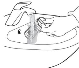
6. Inserire il filtro dell'acqua e reinstallare lo zoccolo: Reinserire il filtro dell'acqua ruotandolo in senso orario. Continuare a ruotare fin dove possibile; l'impugnatura del filtro deve trovarsi in posizione verticale. Per provare la tenuta del filtro, versare circa 1 litro d'acqua nella vaschetta del detersivo. Reinstallare lo zoccolo.
