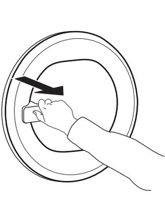
Zum Schließen der Tür, halten Sie den Griff und drücken Sie so, dass Sie die Verriegelung einrasten hören.
