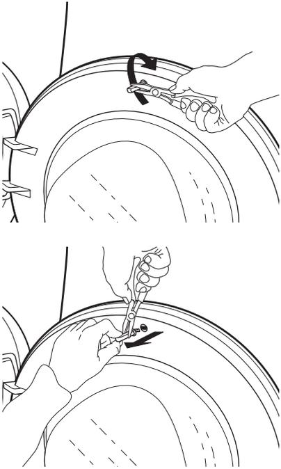
**2.** Die beiden Schrauben oberhalb und unterhalb der Türverriegelung herausdrehen.
