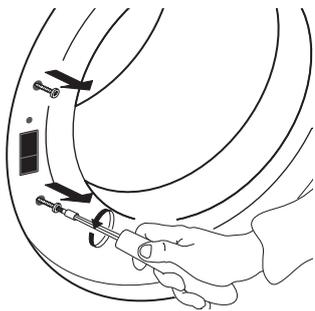
Um die Tür zu entfernen und zu befestigen, wird empfohlen mit einer weiteren Person zu arbeiten. Achten Sie darauf, dass der Trockner vom Netzschalter getrennt ist. Öffnen Sie die Trocknertür.
