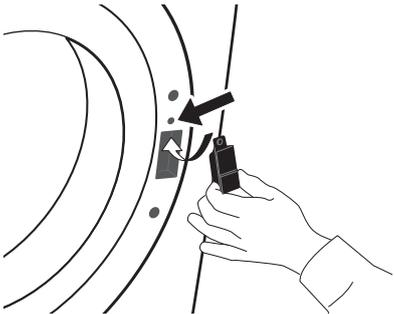
**7.** Die beiden Schrauben oberhalb und unterhalb der Türverriegelung festschrauben.
