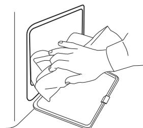
**8.** Bodenfilter wieder einsetzen. Sicherstellen, dass er komplett in das Filterfach eingesetzt ist.
