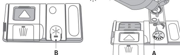
1. Abra el dispensador **B** pulsando y levantando la lengüeta de la tapa.
