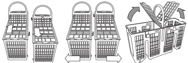
**Los cuchillos y otros utensilios con bordes afilados se tienen que colocar en el canastillo para cuchillería con las puntas hacia abajo o se deben colocar horizontalmente en los compartimentos desplegados de la bandeja superior.**
