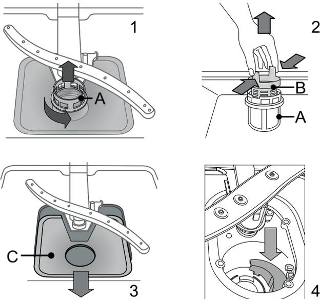
Una vez limpiados los filtros, recolocó el cuerpo de filtrado y encájelo correctamente en su sitio; esto es esencial para garantizar el funcionamiento eficiente del lavavajillas.
