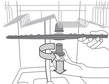
Para extraer el brazo aspersor superior, gire el anillo de cierre de plástico hacia la izquierda. El brazo aspersor superior se tiene que recolocar de tal modo que el lado con más agujeros mire hacia arriba.
