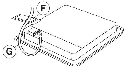
**Uređaj priključite na električno napajanje pomoću višepolnog prekidača za iskopčavanje s razmakom između kontakata najmanje 3 mm.**
