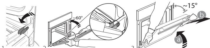
Покладіть зняті дверцята на м'яку поверхню. Щоб встановити дверцята на місце, піднесіть їх до духової шафи, вирівняйте гачки петель з їхніми пазами та закріпіть верхню частину у пазі. Опустіть дверцята, а потім повністю відчиніть їх. Опустіть засувки в початкове положення: Переконайтесь, що вони повністю опущені. Спробуйте зачинити дверцята й перевірте, чи перебувають вони на одній лінії з панеллю керування. Якщо це не так, знову виконайте описані вище кроки.
